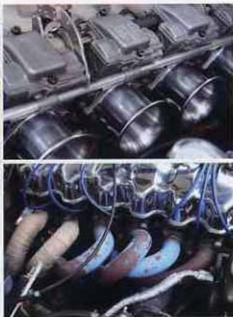
美しい造形美を足せるポリッシュされたナックルヘッド。エンジン本体はノーマルで、ケインズのロングファンネルを装着したFCRの35φキャブとトラストのEXマニがチューニングの基だ。プラグコードはNGK。後方にオフセットされた形状のインマニのため、バルクヘッドのサフェーサーの部分加工している。ACユニットを取り外し、ヒーターブロアもオフセット、右側に少し見えている黒いプラスチック製のプロアモーターのカバーも、実は抜却詰められている。
