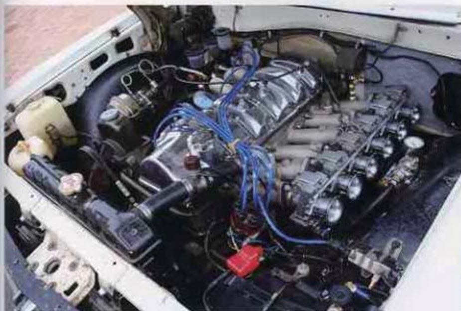
美しい造形美を足せるポリッシュされたナックルヘッド。エンジン本体はノーマルで、ケインズのロングファンネルを装着したFCRの35φキャブとトラストのEXマニがチューニングの基だ。プラグコードはNGK。後方にオフセットされた形状のインマニのため、バルクヘッドのサフェーサーの部分加工している。ACユニットを取り外し、ヒーターブロアもオフセット、右側に少し見えている黒いプラスチック製のプロアモーターのカバーも、実は抜却詰められている。
